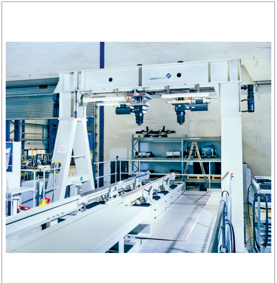
Drehgestell Prüfstand / bogie test bench
