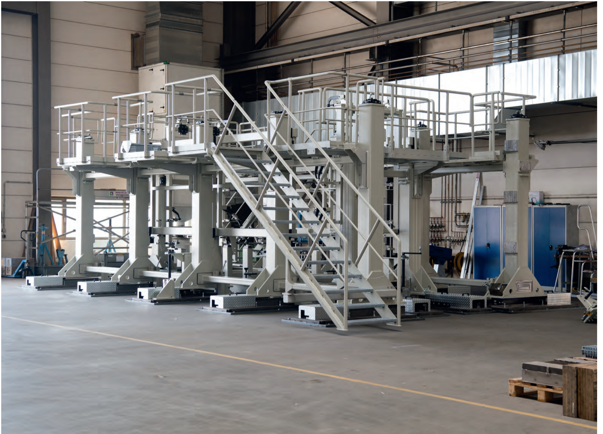
Der Aufbaustand in der Fertigung: Durch die genaue Einstellbarkeit, den integrierten Außenanschlag- und Spannsystemen werden eine hohe Maß- und Wiederholungsgenauigkeit erreicht. Bild: HeiterBlick
