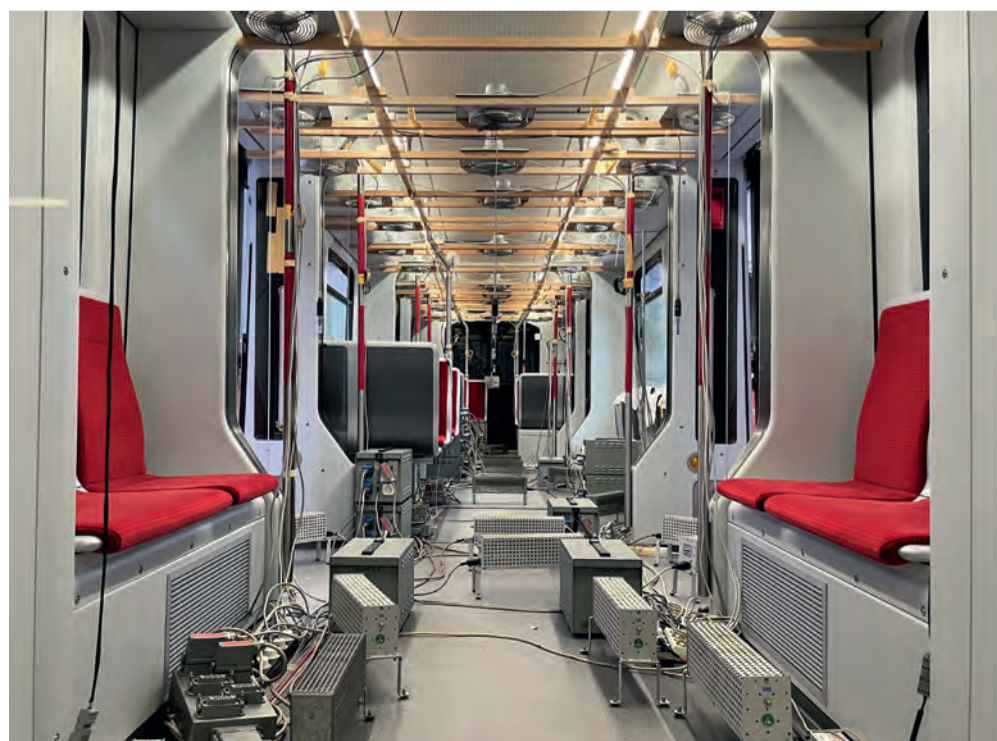
Die installierten Test-Geräte für die Feststellung des k-Wertes des neuen B-Wagens im Klima-Wind-Kanal. Bild: DSW21
